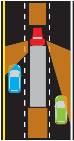
Las zonas naranjas se deben evitar.
